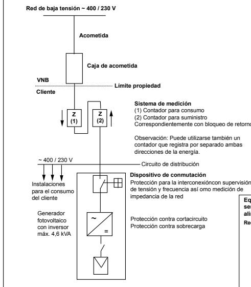
Equipos de producción autónomos individuales en servicio paralelo sin posibilidad de servicio aislado, alimentación monofásica con protección para la interconexión, alimentación por separado.
