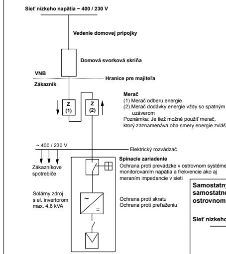
**Samostatný systém výroby elektrickej energie v paralelnej prevádzke bez možnosti samostatnej prevádzky siete, jednofázové napájanie s ochranou proti prevádzke v ostrovnom systéme, samostatné napájanie.**
