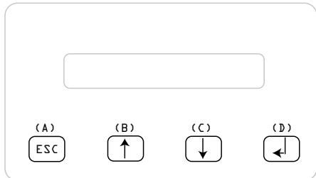
Taste (A), ESC: Zum Wechsel aus den Menüpunkten ins Hauptmenü und zum Ausstieg aus jedem Untermenü.
