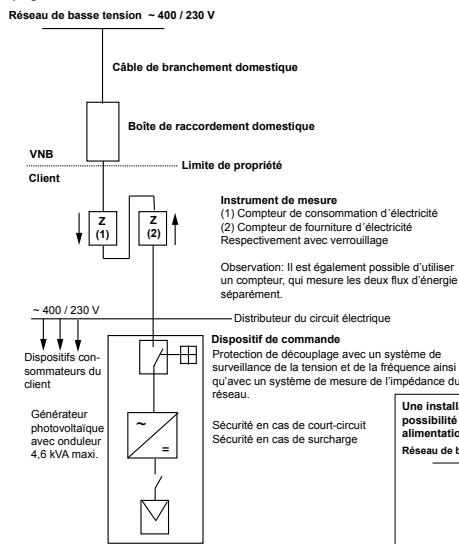
Une installation auto-productrice individuelle en mode de fonctionnement parallèle sans possibilité de régime isolé, alimentation monophasée avec protection de découplage, alimentation à part.
