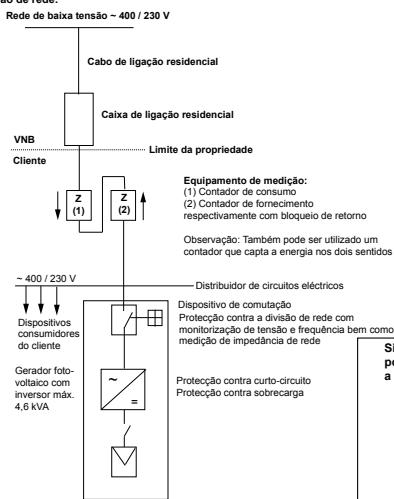
Sistemas próprios geradores de energia individuais em operação paralela sem possibilidade de operação separada, alimentação monofásica com proteção contra a divisão de rede, alimentação em separado.
