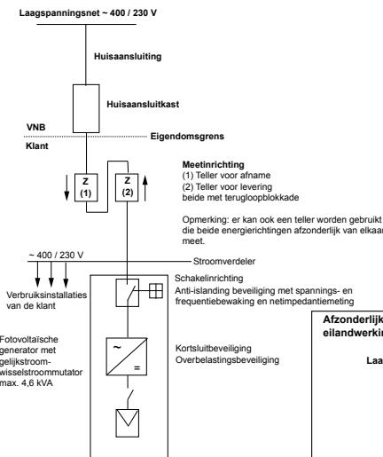
Afzonderlijke zelfopwekkingsinstallatie in parallel gebruik met beveiling tegen eilandwerking, eenfasige voeding met anti-islanding beveiling, afzonderlijke voeding.
