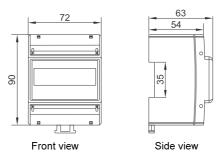
Fig. 2-6 Meter Dimensions (unit: mm)
